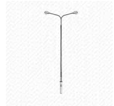
Тип 2 (Опора освещения ОНО-4,5)
